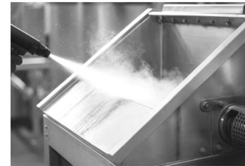
Die Trockendampfreinigung ermöglicht eine ebenso effektive wie schonende Reinigung.
